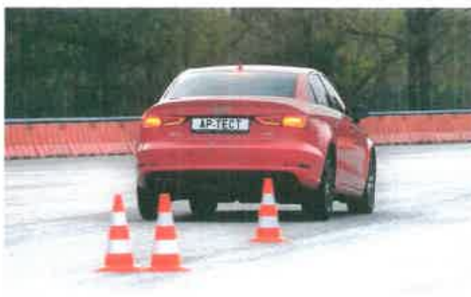
При торможении на сухом асфальте замедление на хороших шинах превышает 11 м/с 2
