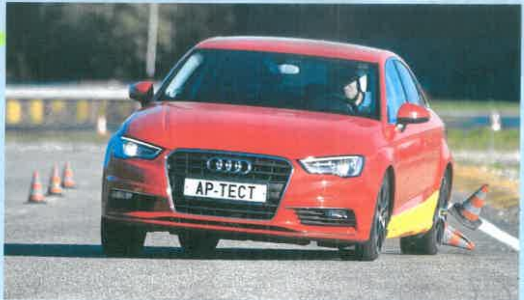
В отсутствие кольцевой трассы мы ограничились «переставкой» — шины оказывают заметное влияние на выполнение этого маневра, имитирующего объезд неожиданно возникшего препятствия
