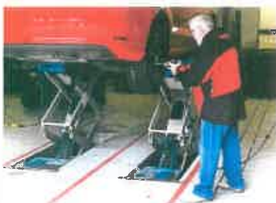
Пневматический гайковерт и удобный подъемник заметно сокращают время смены колес
